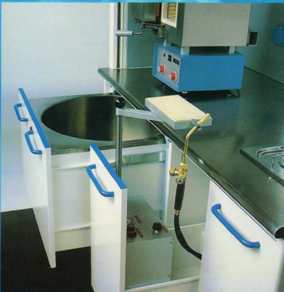
CASSETTONE CENTRIFUGA PER FUSIONI A FIONDA CON BLOCCAGGIO PNEUMATICO O MANUALE. CASSETTONE SALDATURA CON ACCESSORI CENTRIFUGE FOR SLING CASTINGS, WITH PNEUMATIC OR MANUAL CLAMP; WELDING ACCESSORIES DRAWER
